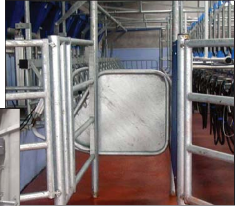
Ferngesteuerte Tore, können überall in der Grube betätigt werden
